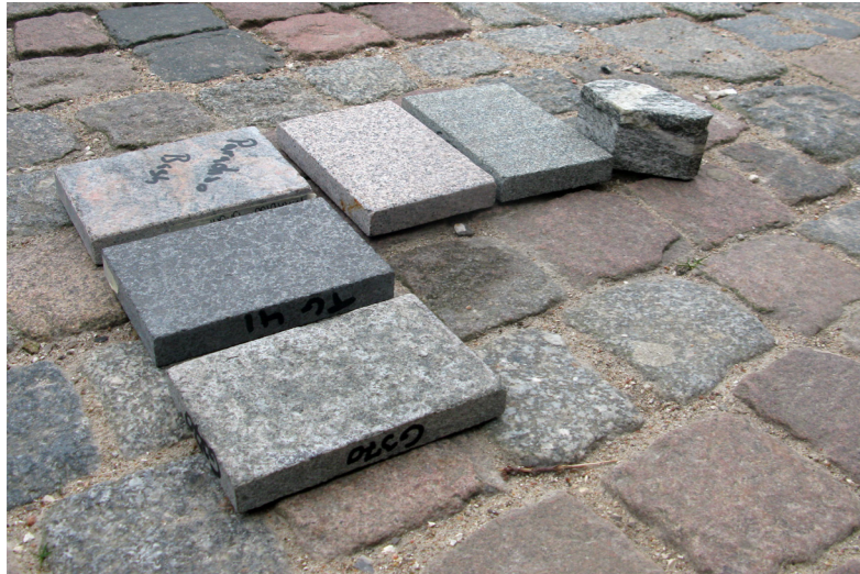
Granitprøver udlagt på eksisterende chaussestensbelægninger i Grenaa. Farver tilpasses eksisterende sten i byen men med jetbrændt overflade
