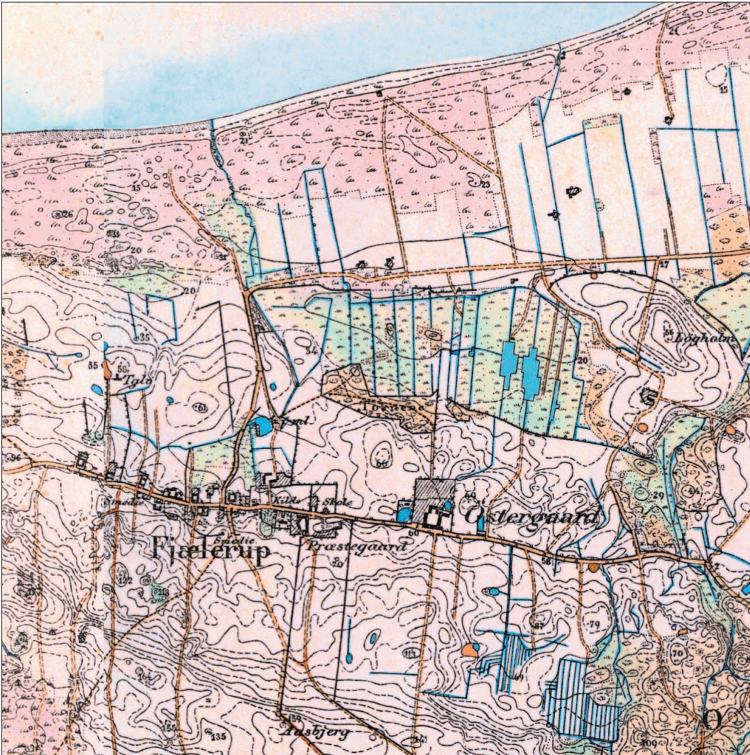
Kortudsnit af de såkaldt Høje målebordsblade fra 1870'erne. De mange og tætliggende højdekurver skyldes ikke kun landskabets ret kuperede karakter, men også det forhold, at kurverne angiver højden i fod (1 fod = 38,31 cm), hvor nyere kort opererer med højdeangivelse i meter.
